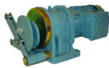
Hubwerk 400/08 2 Exzenter für Viertel - Doppelschlag
